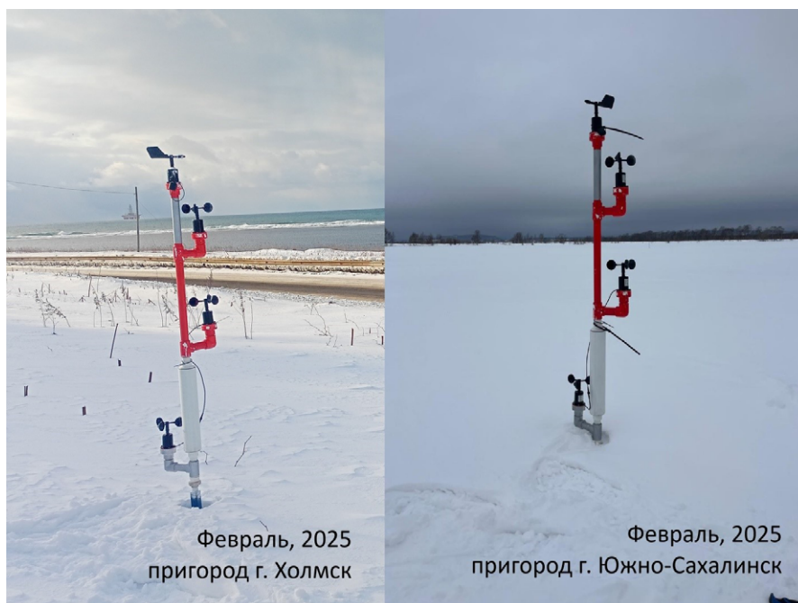
Рис. 1 Автономная метеостанция входящая в состав автономной системы мониторинга снеговетровых процессов
