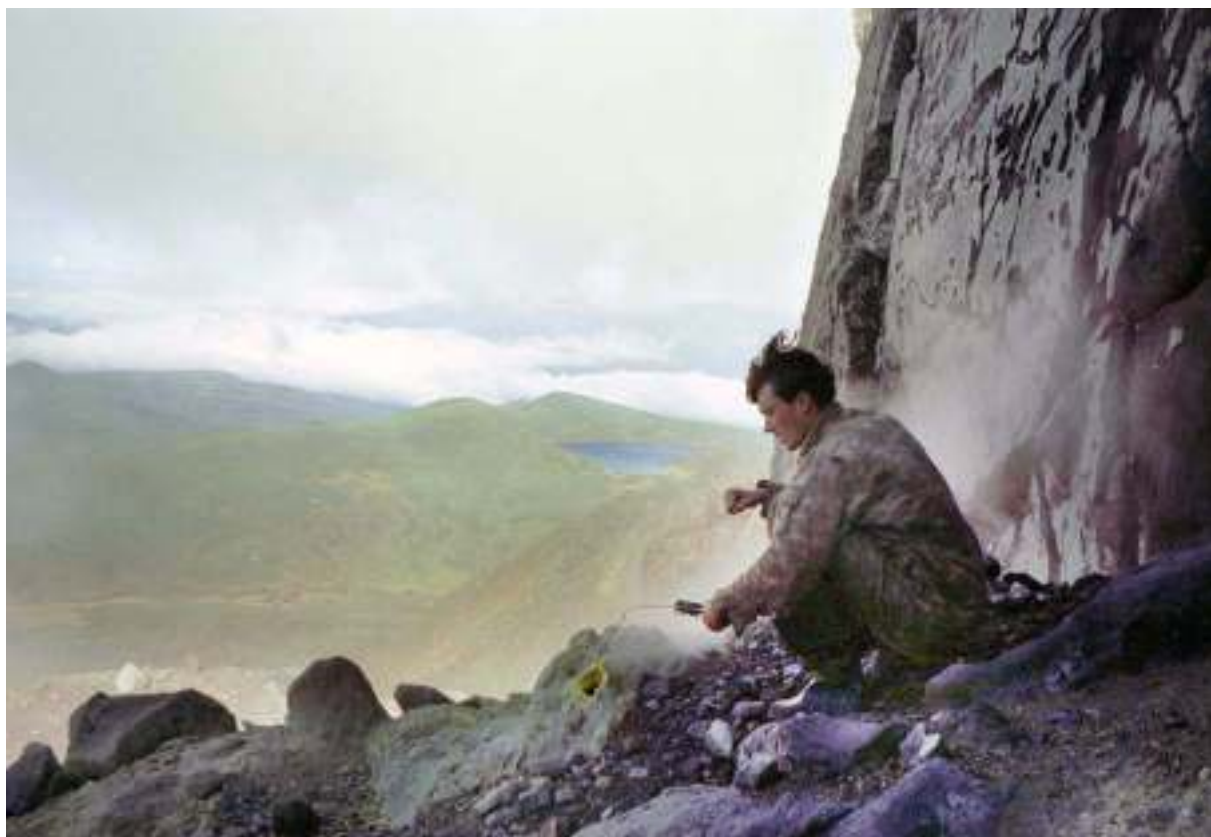
Рис. 254. Измерение температуры сольфатарных газов на бровке взрывной воронки. Фото Д.А. Андриянова, 2004 год.
